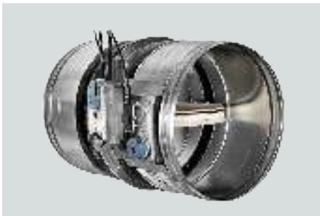
Compuerta Cortafuego marca **LINDAB (Inductair)** WH45-180-315/ ME 220 v- 24 v. Construido según norma y con certificado CE. Fabricada chapa de acero galvanizada, categoría de resistencia EI 180 según normativa Europea Standard UNE 1366-2 y de acuerdo a la EN 15650. Carcasa clase C según EN 1751 y con certificación CE. Montaje con eje de trampa horizontal o vertical, para montaje también en suelo. Incluye motor eléctrico con dos finales de carrera.
